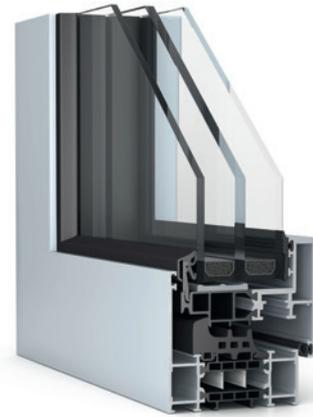
Das verbesserte Verhältnis zwischen Rahmen- und Verglasungsanteil ermöglicht exzellente  $U_w$ -Werte auf Passivhaus-Niveau und einen erhöhten Lichtdurchlass mit Panoramablick.
